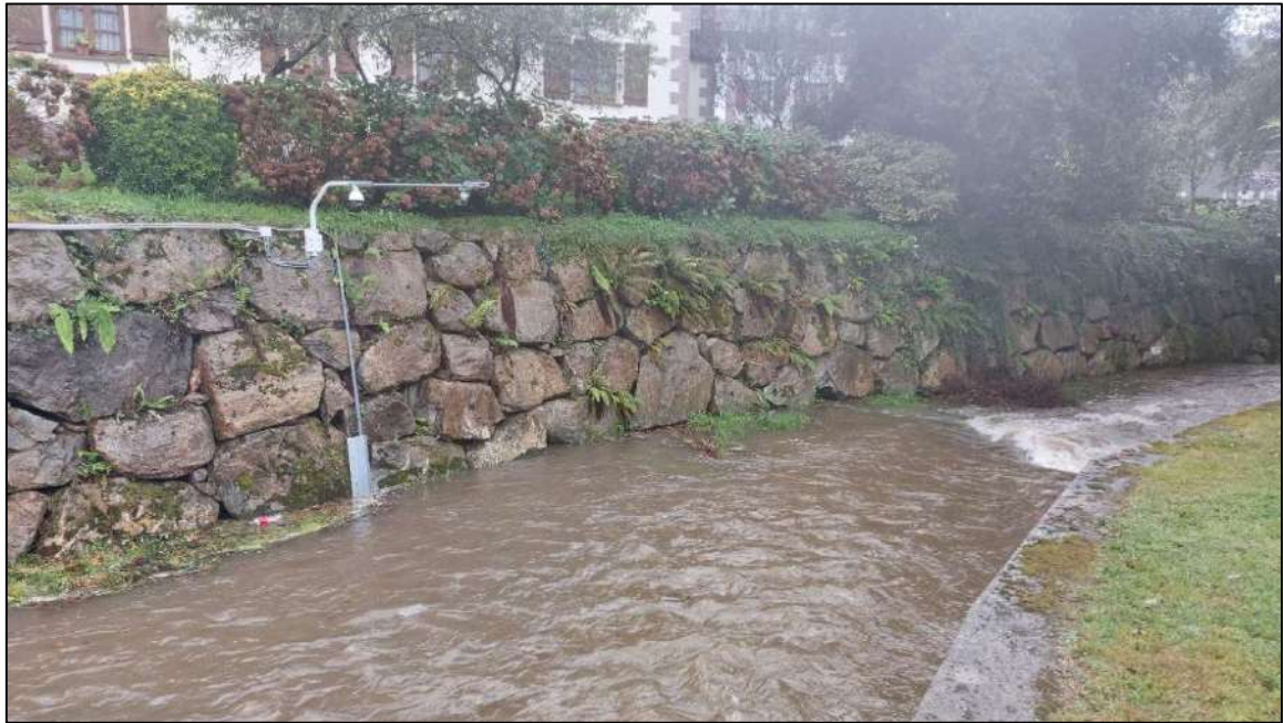
Fotografía de la nueva estación de aforo instalada por la CHC en el río Tximista en el casco urbano de Etxalar. Fuente: GAN-NIK.
